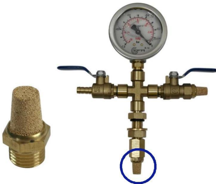
Hangtompító és levegőszelepre szerelt hangtompítóval
